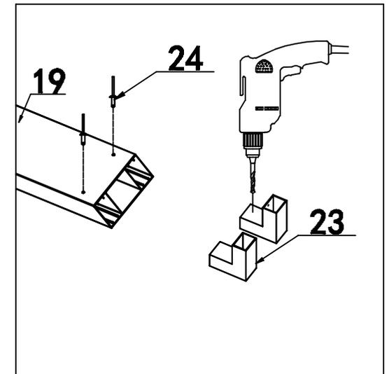
Setzen Sie zuerst den Sims ein, danach bohren Sie die Löcher mithilfe eines Handbohrers.
