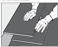
7 Einpassen der letzten Dielenreihe: Legen Sie exakt auf die zuletzt verlegte Dielenreihe die nachzusägende Diele. Dann zeichnen Sie mit Hilfe einer weiteren Diele den Längsschnitt an. Durch diese Art des Anzeichnens bleibt genügend Abstand zur Wand um die letzte Reihe mittels Zugeisen einzuwinkeln.
