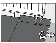
Bei Heizungsrohrdurchbrüchen die Diele am Stoß ausklinken und mit Heizkörperrosetten abdecken.
