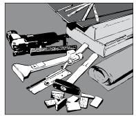
1 Alles bereit? PE-Folie und Klebeband. Als Werkzeug: Zollstock, Bleistift, Stichsäge, Fuchsschwanz, Fäustel, Setzlatte, Zugeisen, ZIRO-Schlagklotz und Abstandskeile.
