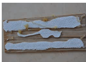
Gitterschnitttest und Klebebandabriss Haftungsprüfung mit Wall Probestück
