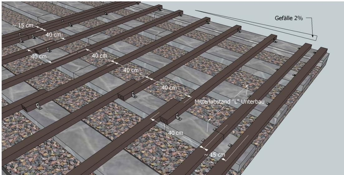
Alternativ können Sie die Unterkonstruktion auch auf Stoß legen, also ohne Überlappung (siehe Bild: zweite UK-Reihe von rechts). Dann müssen Sie die aufeinanderstoßenden UK-Balken mit einem Verbindungsblech untereinander fixieren.
