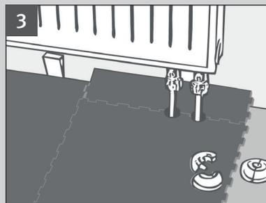
**3** Bei Heizungsrohrdurchbrüchen die Diele am Stoß ausklinken und mit Heizkörperrosetten abdecken.
