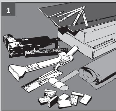
**1** Zur optimalen Verlegung benötigen Sie folgende Werkzeuge und Materialien: Zollstock, Bleistift, Stichsäge, Fuchschwanz, Setzlatte, Gummihammer und Abstandskeile.
