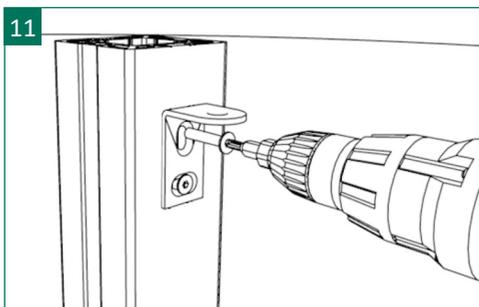
11 | Setzen sie den oberen Scharnierwinkel mit einem Außenabstand zum unteren Scharnierwinkel von 1815 mm mittig auf den Torpfosten. Die Löcher mit einem 3 mm und 7,5 mm Bohrer vorbohren und mit einem M8 Gewindeschneider nachsetzen.
