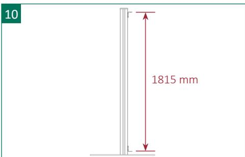
10 | Der Abstand zwischen Oberkante des oberen Scharnierwinkels und Unterkante des unteren Scharnierwinkels beträgt 1815 mm.
