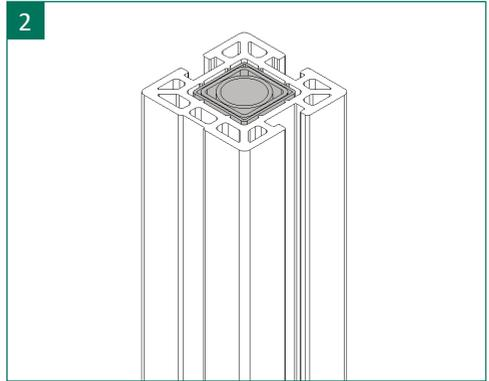
2 | Torpfosten mit Verstärkung (2400 mm lang, GroJaSolid und GroJaViento). Die Torpfostenverstärkung muss auf der Scharnierseite gesetzt werden, um die Stabilität des Tores zu gewährleisten. Es ist darauf zu achten, dass die geschlossene Pfostenseite nach innen zeigt.
