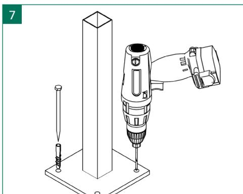
7 | Alternativ können bei bauseits vorhandenem Betonfundament oder Mauersockel Konsolen zum Aufschrauben Verwendung finden. Diese werden vom Maß her identisch wie beim Betonieren ausgerichtet und mit einer geeigneten Schrauben-/Dübelkombination befestigt.
