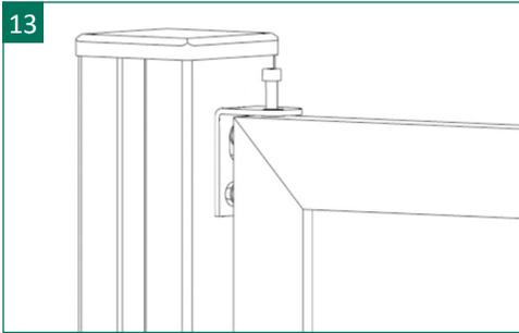
13 | Das Tor aufrichten, die Innensechskantschraube und Kunststoffunterlegscheibe (zwischen Scharnierwinkel und Torrahmen) ein schrauben. Die Schraube eindrehen so dass der Kopf der Schraube im Winkel verschwindet.
