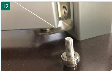
12 | In die Unterseite des Torblattes die Innenechskantschraube mit Gleitlager und Metallunterlegscheibe einschrauben und in den unteren Scharnierwinkel einsetzen.
