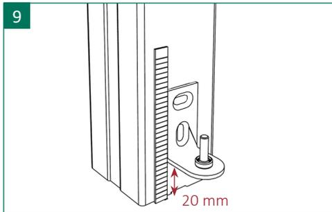
9 | Setzen sie den unteren Scharnierwinkel mit einem Maß von 20 mm mittig auf den Zaunpfosten. Die Löcher mit einem 3 mm und 7 mm Bohrer vorbohren und mit einem M8 Gewindeschneider nachsetzen.
