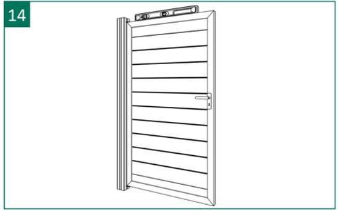
14 | Die waagerechte Ausrichtung des Torelements mit der Wasserwaage kontrollieren, gegebenenfalls korrigieren und mit einer Holzleiste stabilisieren.
