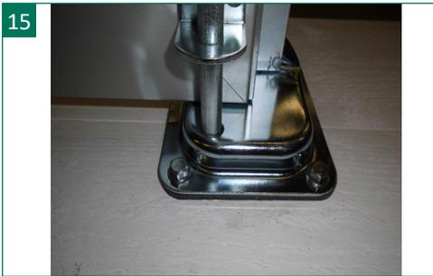
15 | Den Bodenriegel passend zur Auflaufstütze montieren
