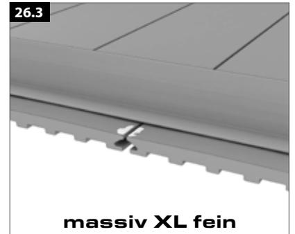
Punktueller Ankleben des WPC-Winkelprofils oder der Abschlussleiste am Profilrand mit Hilfe von LIGNODUR® Montageklebstoff. \*1)
