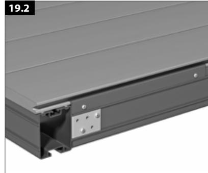
Bei einer Rahmenkonstruktion kann die erste Diele mit Hilfe des Startprofils befestigt werden. Der Mittenabstand der Startprofile sollte maximal 1,0 m betragen.
