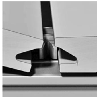
Die folgende Bodendiele **richtungsgleich** in einem Winkel von ca. 15° an den Montageclip ansetzen und unter den Kopf des Montageclips bis zum Anschlag schieben. Zur richtungsgleichen Verlegung dient die Nut unterhalb der Bodendiele. Bitte richten Sie die Nut immer in gleicher Positionierung aus. Zusätzlich ist auf der Dielenrückseite ein Richtungspfeil aufgedruckt.
