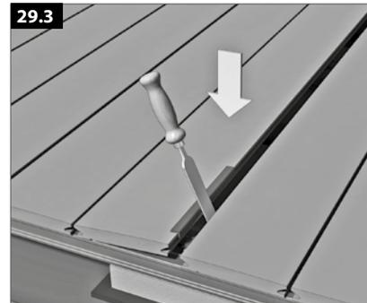
Die neue Diele unter den Clips einschieben und mit dem Stecheisen spreizen, bis die Diele aufliegt. Durch Verschieben ein gleichmäßiges Fugenbild herstellen.
