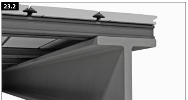
Nur bei einer mind. 10 cm hohen, aufgeständerten und vollständig unterlüfteten Gesamtkonstruktion kann ein Nutprofil zum Verschließen der Fugen eingesetzt werden.
