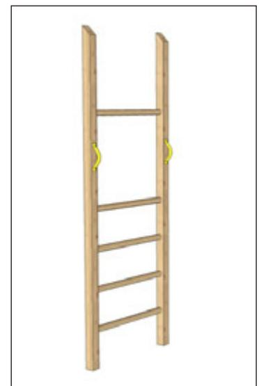
Die cm Angaben sind vom Nullpunkt bis Oberkante Sprosse. Alle Sprossen werden mit 2 Schrauben befestigt.
