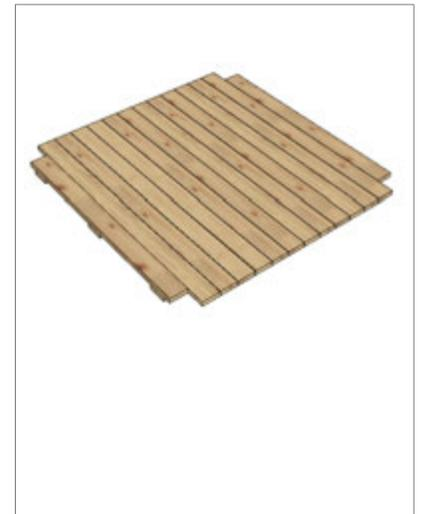
Jedes Podestbrett wird mit fünf Schrauben befestigt (außen jeweils zwei und mittig eine Schraube).
