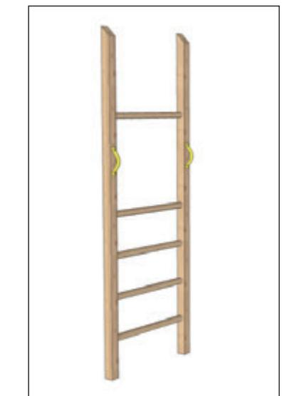
Die cm Angaben sind vom Nullpunkt bis Oberkante Sprosse. Alle Sprossen werden mit 2 Schrauben befestigt.
