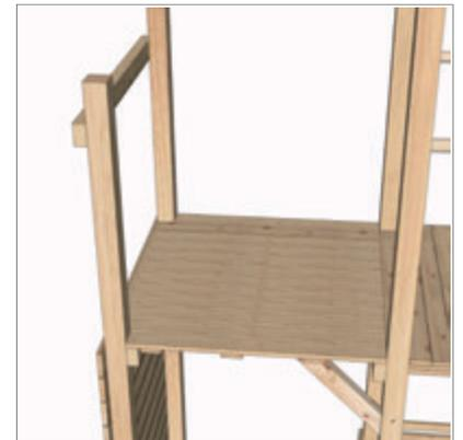
Jedes Podestbrett wird mit fünf Schrauben befestigt (außen jeweils zwei und mittig eine Schraube).
