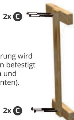
Jede Absturzsicherung wird mit vier Schrauben befestigt (jeweils zwei oben und zwei Schrauben unten).
