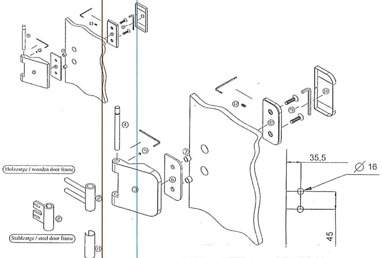
1. Gummihülsen (7) in die Glasbohrungen stecken, Bandteil (3) mit fest verklebtem Gummi (bei Ausführung Edelstahl mit Platte (6) mit der Gegenplatte (8) durch Senkkopfschrauben (9) befestigen.
