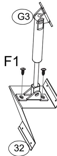
**36** Montieren Sie die Gasdruckfeder **[G3]** mit den Schrauben **[F1]** auf den Metallwinkel **[32]**.
