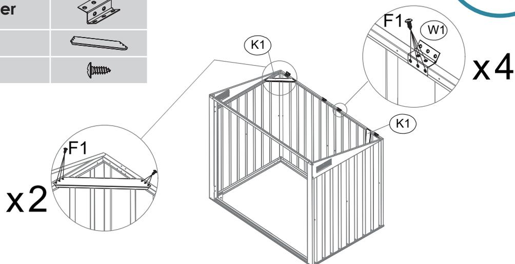
**18** Montieren Sie die Winkelscharniere **[W1]** auf der Rückwandverstärkung **[19]**. Zum Befestigen verwenden Sie die Schrauben **[F1]**. **Wiederholen Sie diesen Schritt drei weitere Male.**
