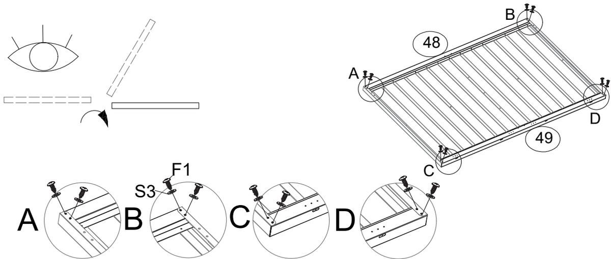
**30** Verbinden Sie an jede Ecke mit zwei Schrauben **[F1]** und zwei Unterlegscheiben **[S3]** die Kehlbleche **[48/49/50/51]** miteinander.
