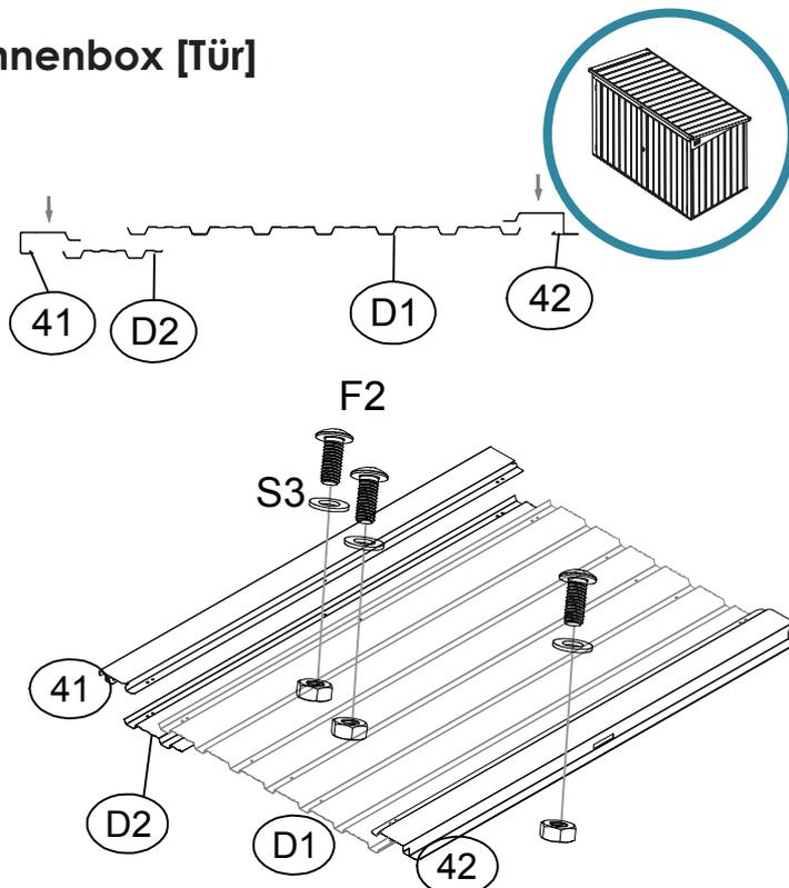
**20** Legen Sie den den Türflügel **[D1]** und **[D2]** auf die Türverstärkung **[41/42]** und verschrauben beides mit den Schrauben inkl. Mutter **[F2]** und den Unterlegscheiben **[S3]**.
