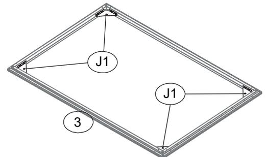
**2** Fügen Sie an jede Ecke der Bodenprofile [1/2/2-1/3] mit vier Schrauben [F1] einen Eckverbinder [J1].
