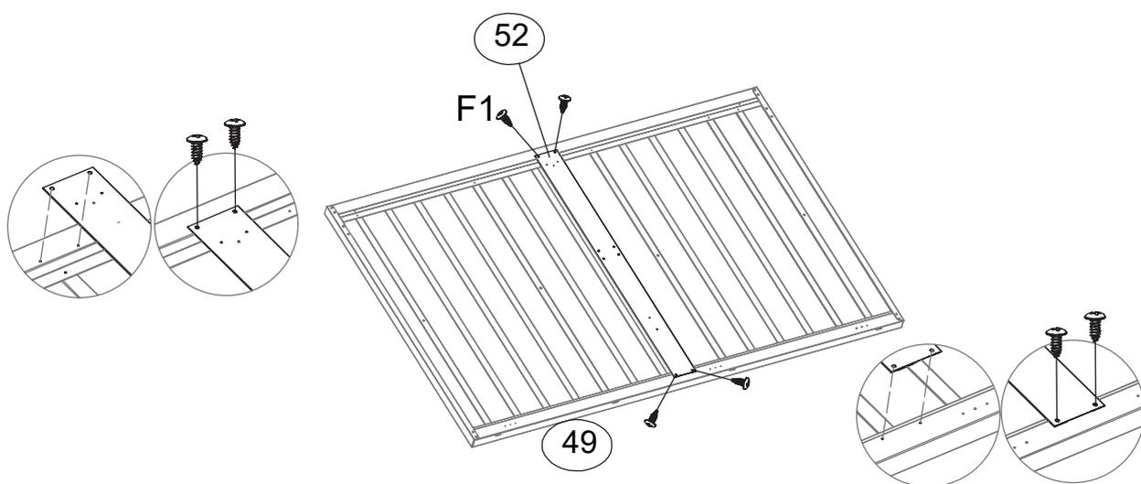
**31** Legen Sie das Dachelement Mitte **[52]** an die Kehlbleche **[48/49]** und fixieren diese mit den Schrauben **[F1]**.
