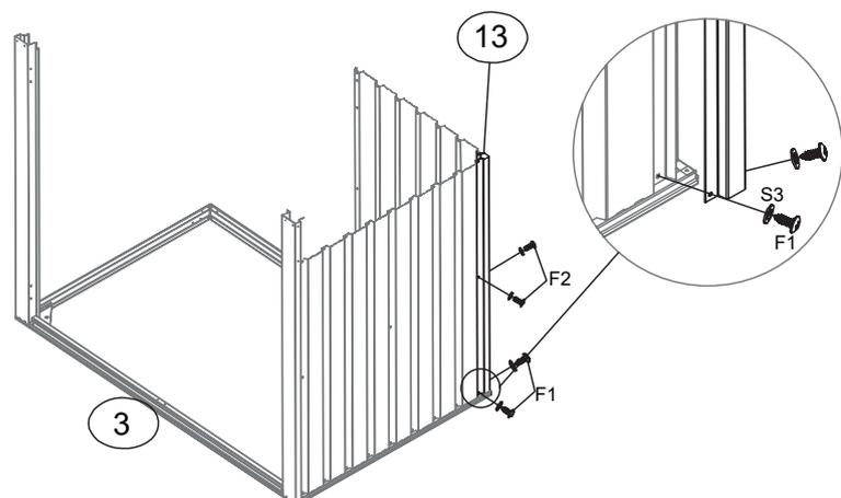
**7** Stellen Sie einen Eckverstärker **[13]** an das Seitenelement **[P1]** und die Rückwand **[P7]** und verbinden Sie diese mit den Schrauben **[F1]** und den Unterlegscheiben **[S3]**.
