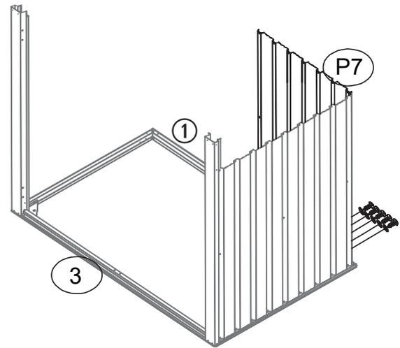
**6** Stellen Sie die Rückwand **[P7]** auf die Bodenkonstruktion und verbinden Sie diese mit dem Bodenrahmen **[1]**. Verwenden Sie dafür die Schrauben **[F1]** und den Unterlegscheiben **[S3]**.
