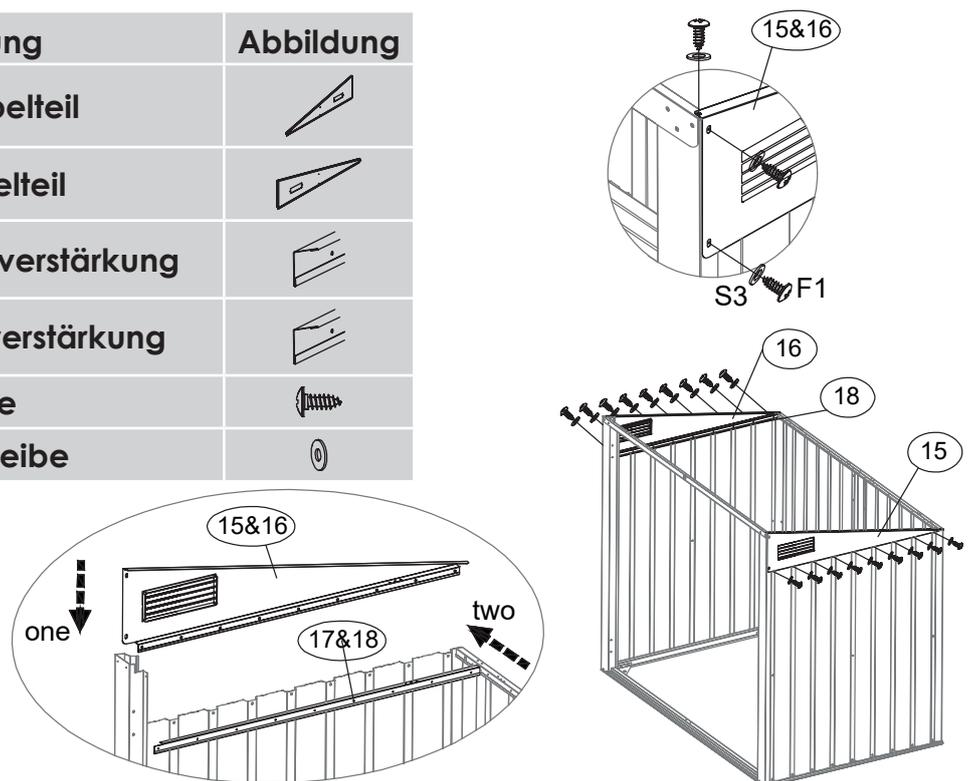
**17** Befestigen Sie den rechten Giebelteil [15] auf der rechten Türschiene [4R]. Verbinden Sie mit den Schrauben [F1] und den Unterlegscheiben [S3] das rechte Giebelteil [15] mit der rechten Seitenwandverstärkung [17] und dem Seitenelement [P1].
