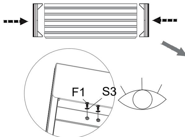
**21** Montieren Sie die obere und untere Türverkleidung aus Schritt **20** auf die fertige Türverkleidung und fixieren Sie diese mit den Schrauben **[F1]**, den Schrauben inkl. Mutter **[F2]** und den Unterlegscheiben **[S3]**.
