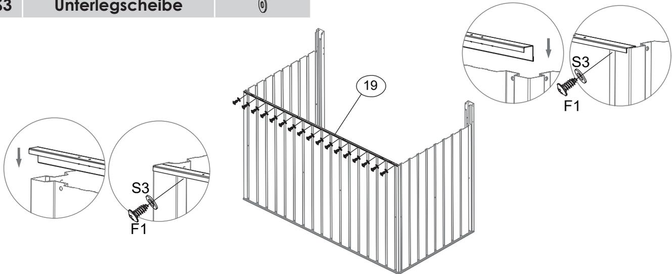
**12** Befestigen Sie die Rückwandverstärkung **[19]** auf der oberen Innenseite der Rückwandelemente. Verwenden Sie dafür die Schrauben **[F1]** und die Unterlegscheiben **[S3]**.
