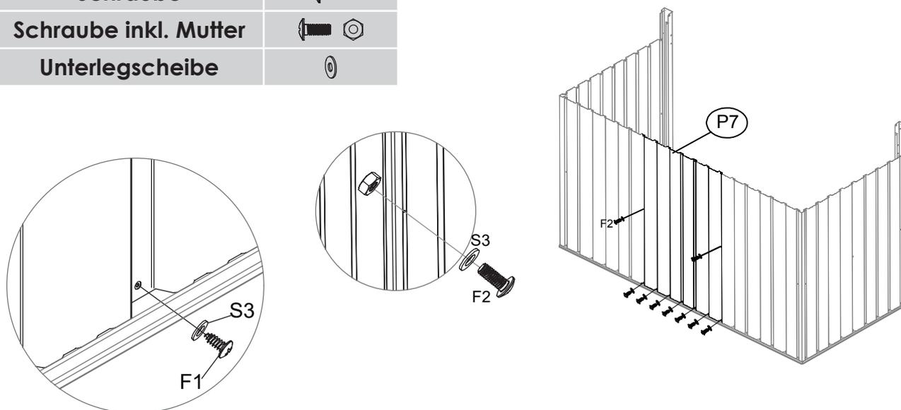
**11** Stellen Sie das Seitenelement [P7] in die Mitte und verbinden es an die Rückwand [P7]. Verbinden Sie diese mit den Schrauben [F1] und den Unterlegscheiben [S3].
