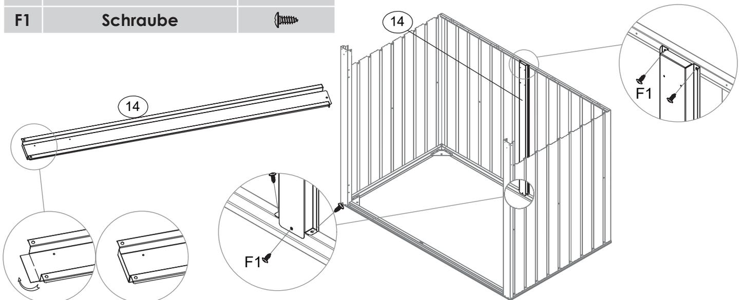
**13** Stellen Sie die mittlere Rückwand **[14]** an die Seitenelemente **[P1]** auf die Bodenkonstruktion und verbinden Sie diese mit der Bodenleiste **[1]** und der Rückwandverstärkung **[19]**. Verwenden Sie dafür die Schrauben **[F1]**.
