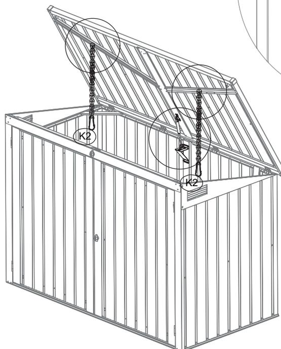
**37** Montieren Sie das fertige Element aus Schritt **36** mit den Schrauben **[F1]** an das Dach und das Grundgestell der Mülltonnenbox.
