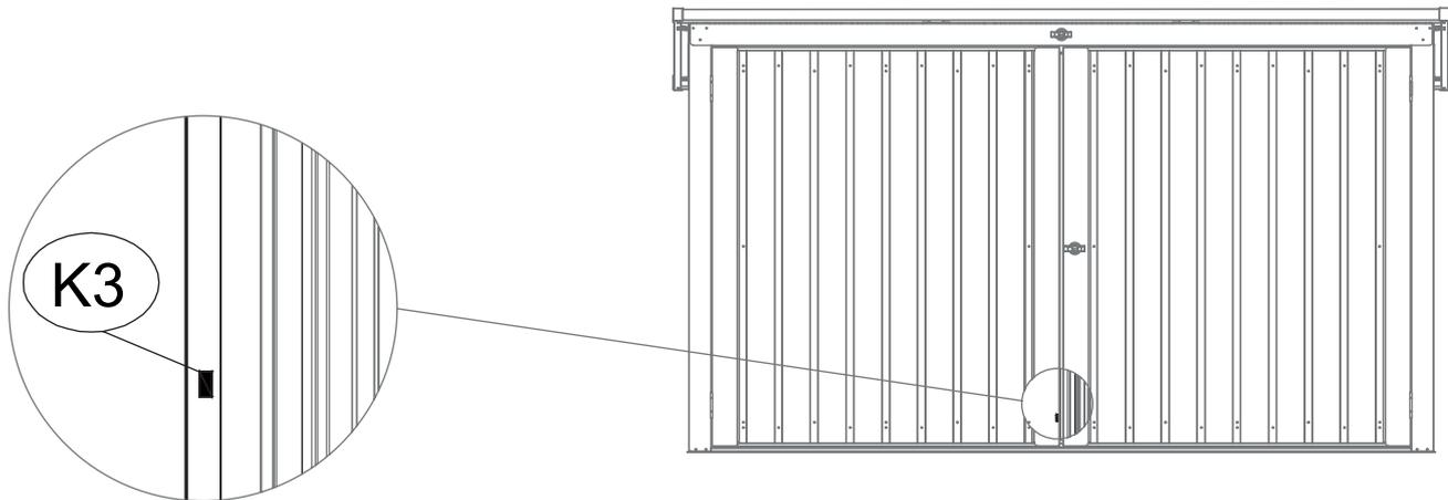
**38** Montieren Sie den Türmagneten **[K3]** an der Innentür.
