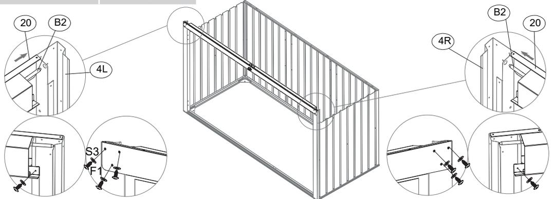
**16** Befestigen Sie die vordere Wandverstärkung [20] auf die linke [4L] und die rechte Türschiene (4R). Verwenden Sie dafür die Schrauben [F1] und die Unterlegscheiben [S3].
