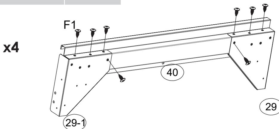
**19** Montieren Sie die Eckverbinder **[29/29-1]** mit den Schrauben **[F1]** an die obere und untere Türverstärkung **[40]**. **Wiederholen Sie diesen Schritt drei weitere Male.**
