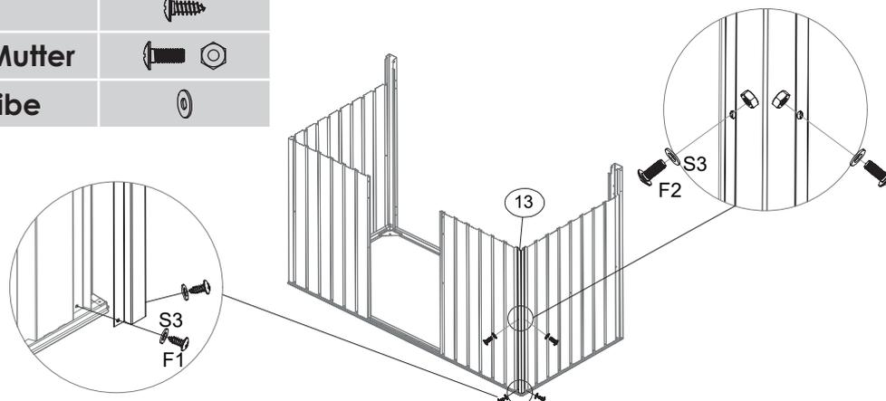
**10** Stellen Sie einen Eckverstärker [13] an das Seitenelement [P1] und die Rückwand [P7] und verbinden Sie diese mit den Schrauben [F1] und den Unterlegscheiben [S3].
