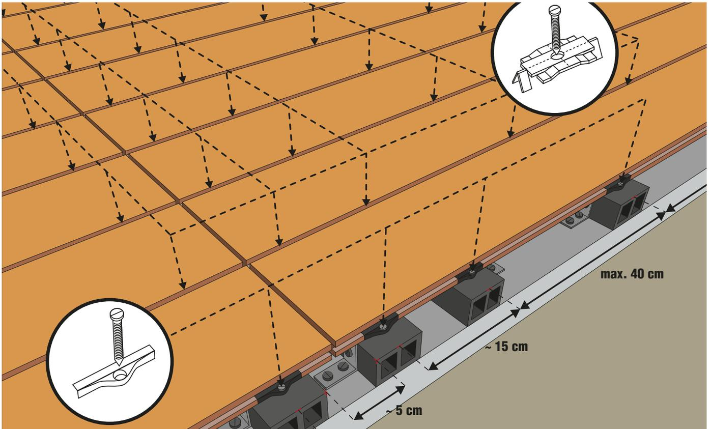
**Abb 4: Abschlussarbeiten (Kantenabschluss)**
