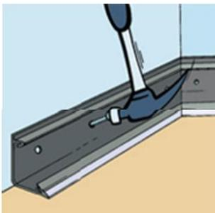
1. Die Funktionsleiste (durchlaufend) an die Wand schrauben, kleben oder nageln. Dann die Dichtlippe eben drücken.
