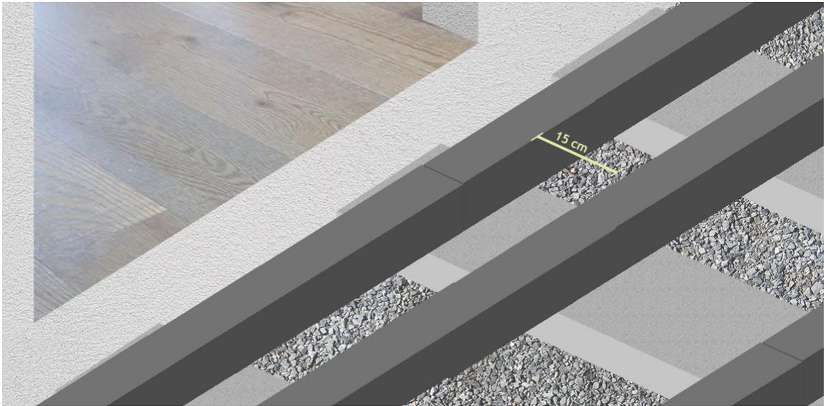
Erste und letzte UK als Doppelreihe mit einem Mittenabstand von ca. 15 cm verlegen und an den Auflagepunkten befestigen.
