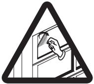
[C000391] Die Schutzfolie ist sofort nach der Tormontage von der Scheibenoberfläche zu entfernen.
