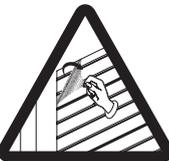
[C000388] Nach der Tormontage ist die Schutzfolie aus Blech des Torflügels und -rahmens unverzüglich abzunehmen.
