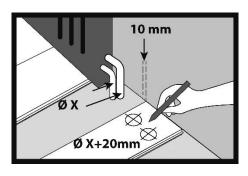
Bei Heizungsrohren, müssen Öffnungen mit einem Durchmesser eingezeichnet werden, der 20 mm größer ist als der Rohquerschnitt.
