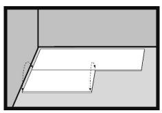
Klopfe vorsichtig mit einem rückschlagfreien Hammer (weißes Gummi) auf die Verbindung der Stirnseite und schließe das Schloss in der Reihenfolge der Schläge 1 und 2. Bei korrekt geschlossenem Schloss sollte die Oberfläche der Paneele in einer Ebene liegen und es sollte keinen sichtbaren Höhenunterschied zwischen den verbundenen Elementen geben.
