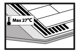
Die Restfeuchte des Estrichs sollte bei der Montage auf einer Fußbodenheizung folgende Werte nicht übersteigen: 1,5 % CM für Zementestrich und 0,3 % CM für Anhydritestrich.
