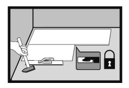
Schlagen Sie das Paneel auf der langen Seite mit einem Schlagklotz ein. Beim Montieren der Paneele sollten die Schlösser immer auf der langen Seite eingeschlagen werden.
