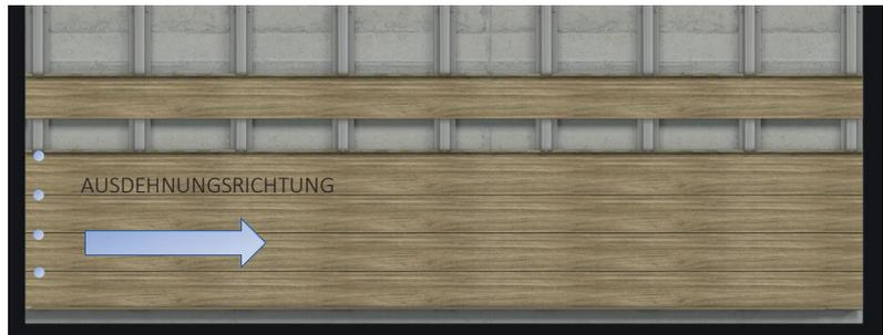
**Option 02** Jedes Paneel sollte in der Mitte fest verschraubt werden, um eine Ausdehnung nach rechts und links zu ermöglichen.
