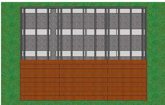
Unterbau, UK und Deck bei versetzten Stößen. Achsmaße: 100-350-350...350-100-350...350-350-100 mm
