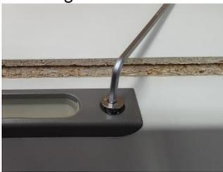
11. Z-Winkel mit beiliegenden Inbusschrauben mit dem Schließblech verschrauben
