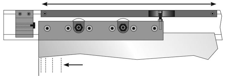
**11** Abdeckprofil auf Schiene montieren
