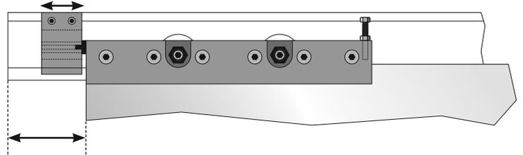
**9** Aushebelschutz justieren
