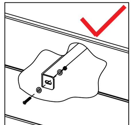
**Bild 11: Befestigen Sie die Schrauben durch die durchgestanzten Löcher an den Zugstangen.**
