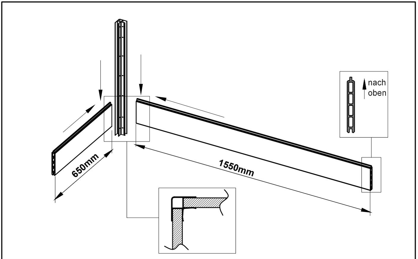
**Bild 1:** Montieren Sie zwei WPC-Elemente mit unterschiedlichen Abmessungen in den Nuten der Aluminiumpfosten und richten Sie die Unterkanten der WPC-Elemente an den Aluminiumsäulen aus. (Montieren Sie die Pflanzkästen auf einem flachen und ebenen Untergrund.)
