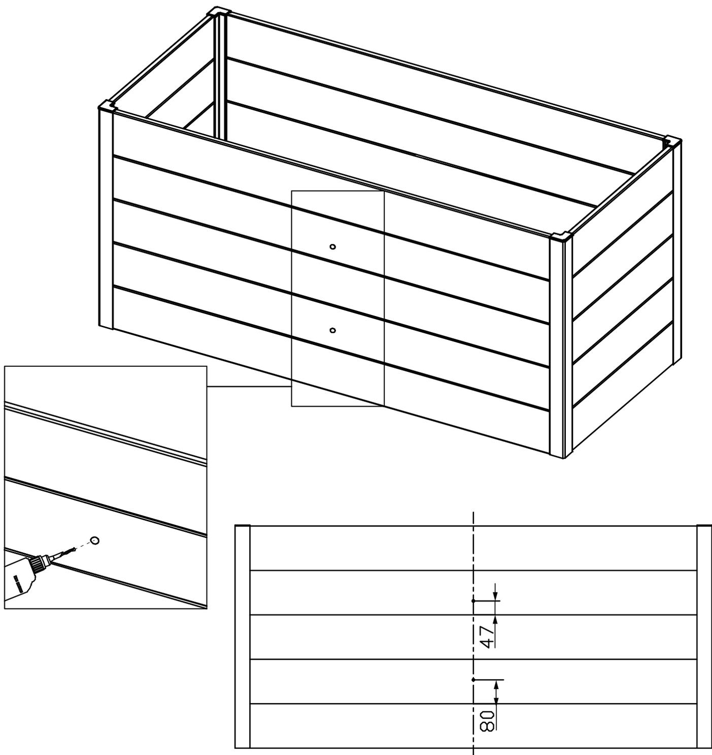
Bild 10: Benutzen Sie gemäß der obigen Zeichnung einen  $\varnothing$  8mm-Bohrer, um Löcher in die Mitte der Holz-Kunststoffplatte zu bohren.
