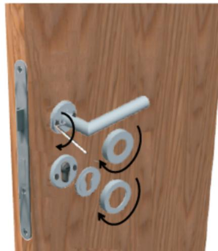
Schrauben Sie die Madenschraube in das Gewinde im Drücker und ziehen diese mit dem mitgelieferten Inbusschlüssel fest, bis diese in den Stift eingebrochen ist.
