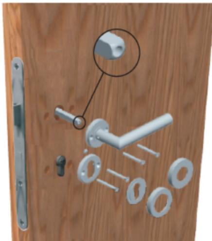
Schieben Sie die Drückerrosette auf den Vierkantstift und verschrauben Sie diese mittels 2 Schrauben mit dem Außenschild.
