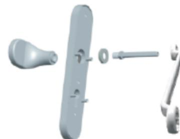
Befestigen Sie den Rollenwechselstift mit einem passenden Ringschlüssel gem. Abbildung.
