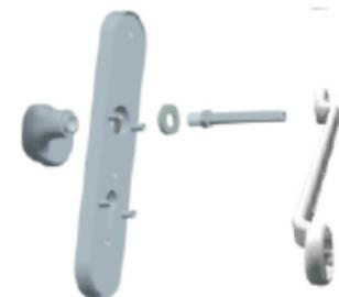
Befestigen Sie den Rollenwechselstift mit einem passenden Ringschlüssel gem. Abbildung.
