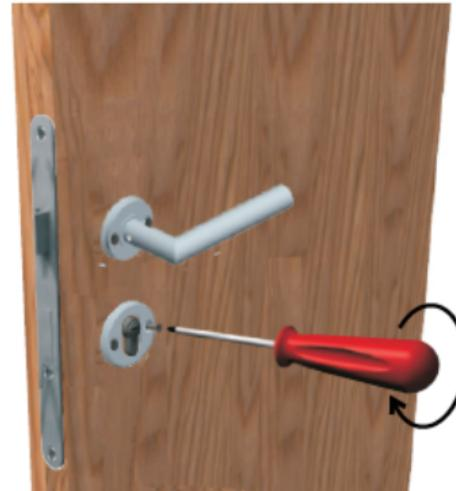
Ansicht nach Verschraubung der Drücker- und Schlüsselrosette.
