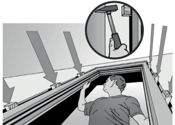
**8** **DE:** Markieren Sie die Punkte für Dübelbohrungen im Mindestabstand von 15 cm aus der Ecke heraus und maximal 50 cm zwischen den einzelnen Bohrungen.
