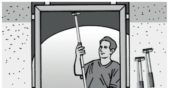
**5** **DE:** Richten Sie den Elementrahmen durch das Unterlegen von Montageklötzchen lot- und waagrecht aus. Beachten Sie dabei die Einbauhöhe.
