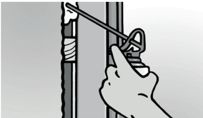
**16** **DE:** Achtung: Bei der Verwendung von Montageschaum muss der Rahmen ausgepreizt werden.
