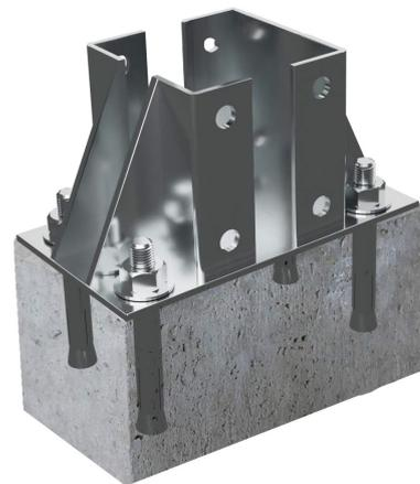
**Konsole zum Aufschrauben:** Befestigen Sie die Dehnschrauben in den Beton (das vorhandene Fundament sollte die Mindestmaße 35x35x60cm haben). Platzieren Sie dann die Konsole, wie im Bild, und fixieren Sie diese mit den Muttern.
