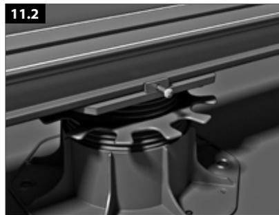
Der Stellfuß kann mittels Holzschraube an den UK-Profilen 35 x 80 mm fixiert werden.
