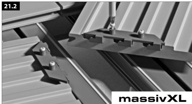
Die beiden Teile wie dargestellt mit den Zapfen anlegen und befestigen. Den nicht benötigten Zapfen abbrechen. **Profile bitte vorbohren.**
