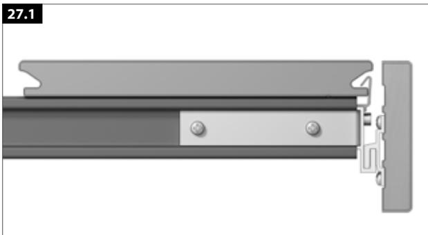
Mit Hilfe der „Blendenaufnahme stirnseitig“ wird die Blende in Längsrichtung der Dielen im Mittenabstand von maximal 80 cm stirnseitig an den UK 35 x 80 mm befestigt. (bei zu erwartender Belastung der verblendeten Seite die Blendenaufnahme an jeder UK fixieren)
