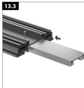
Bei den UK-Profilen 35 x 160 mm und 80 x 160 mm wird der Verbinder von oben verschraubt.
