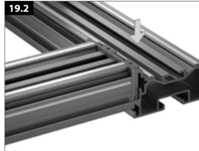
Der Steckverbinder wird mit den Haken nach unten in die Kanäle der UK-Profile eingesteckt.
