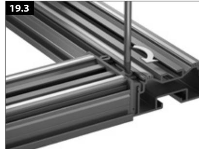
Nach erfolgter Positionierung muss der Steckverbinder durch die Fixierung zweier Klemmsteine gesichert werden.
