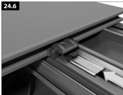
Nach der Montage der Diele wird der Fixierungseinsatz in die Montagenut eingesetzt und bis zum Montageclip geschoben.
