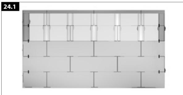
Bei einer Länge der Fläche unter 4 m werden die Fixierungseinsätze nur aussen verwendet.
