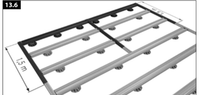
Der Profilverbinder darf bei selbsttragenden Rahmen nicht verwendet werden:
