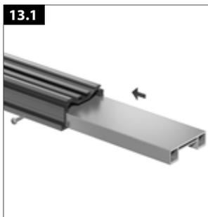
Der Profilverbinder wird zur Hälfte (20 cm) in die UK-Profile eingesteckt.
