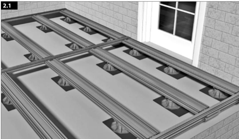
Gemäß dem allgemeinen Stand der Technik soll die Unterkonstruktion als Rahmen ausgeführt werden. Dieser Aufbau ist sowohl für verschraubbare als auch nicht verschraubbare Untergründe geeignet.
