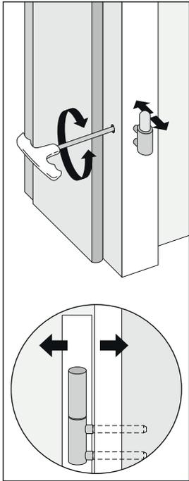
Wenn das Türblatt ungleichmäßig an der Zarge oder mit zu viel Druck auf dem Dämpfungsprofil aufliegt, können Sie den Abstand zwischen Türblatt und Zarge wie folgt verstellen:
