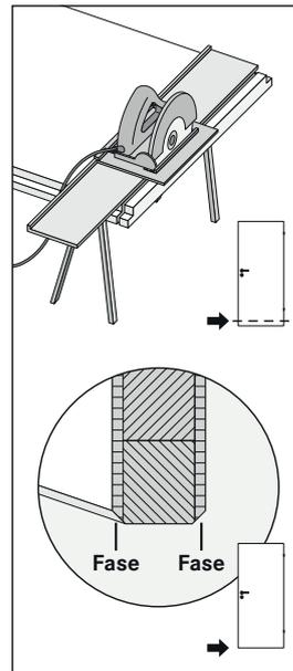
Wenn das Türblatt deutlich zu lang ist und auf voller Breite über den Boden schleift, können Sie das Türblatt unten vorsichtig kürzen.
