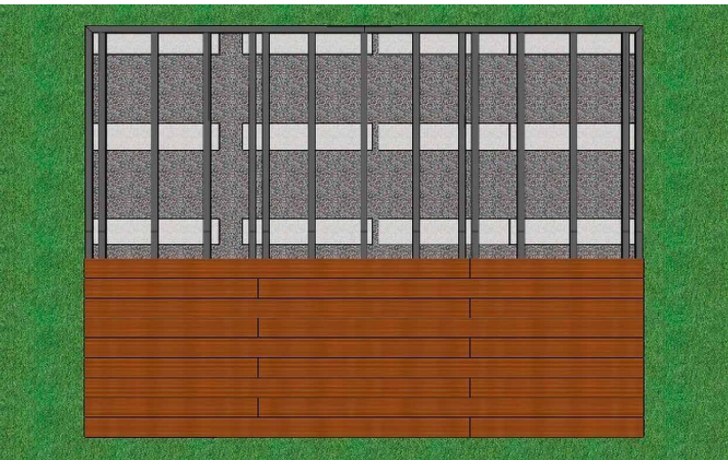
Unterbau, UK und Deck bei versetzten Stößen. Achsmaße: 100-300-300...300-100-300...300-300-100 mm
