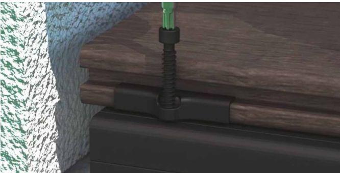
Alle übrigen Befestigungen erfolgen versteckt in den Fugen mit System49 Verbindungsclips.
